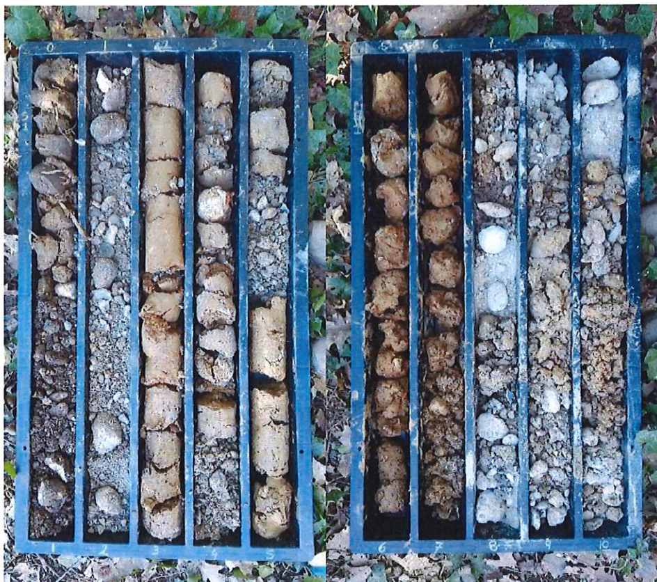
Fig. 2 – Sondaggio 1 da 0.0 a 5.0 / da 5.0 a 10.0 m da p.c.
