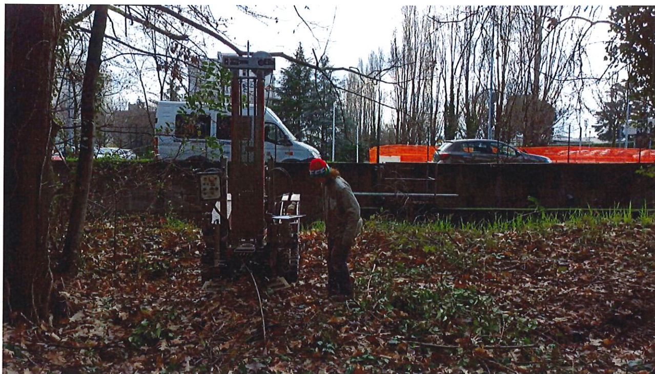
Fig. 3 – Postazione prova penetrometrica dinamica
